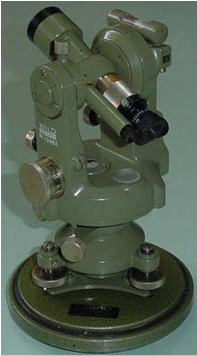
Figura 2.20. Teodolito Brújula Wild T0 con micrómetro óptico
